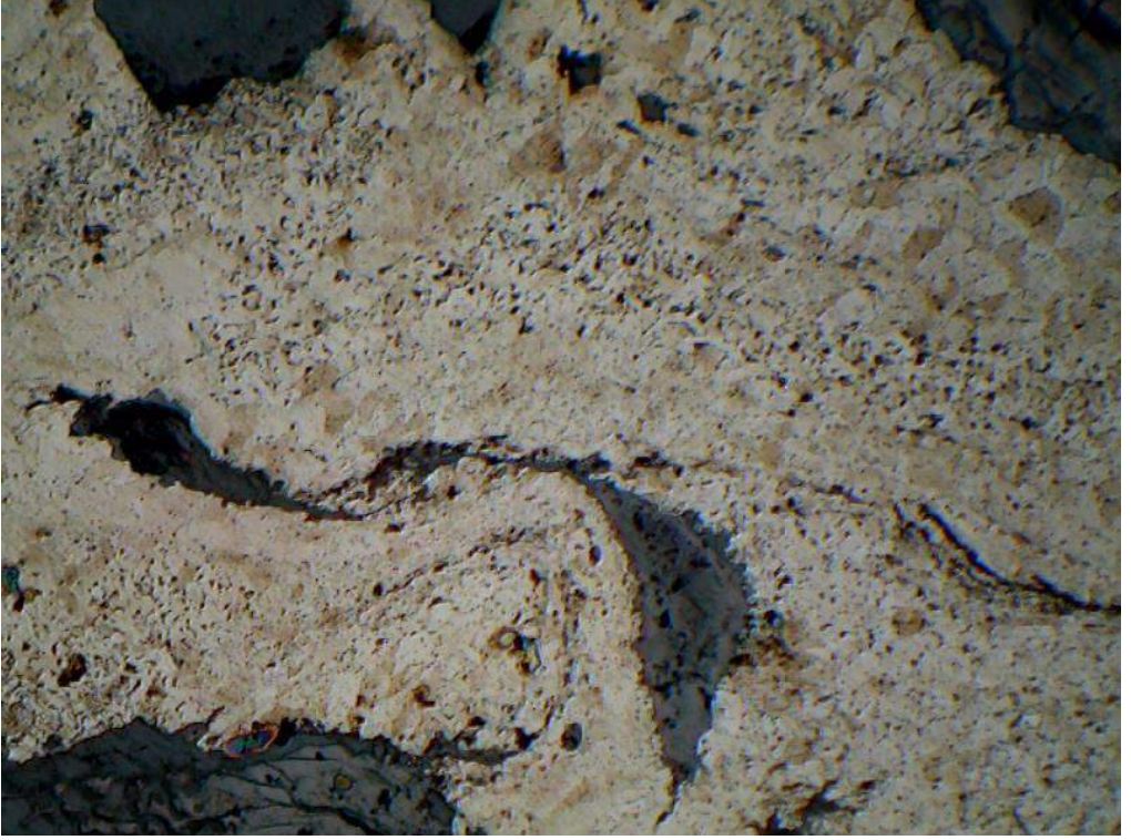
Foto 4. SA-127 kodlu temrenin içyapısında görülen kıvrılma ve birleşme hatları
