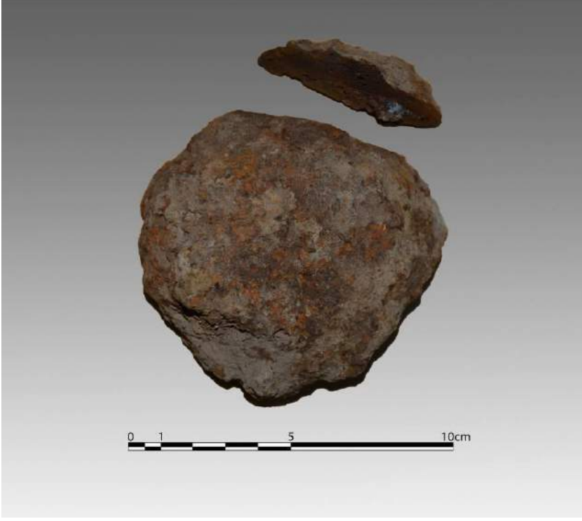
Foto 1 Samsat buluntuları arasında yer alan kase formunda demir külçe ve kesilen numune
